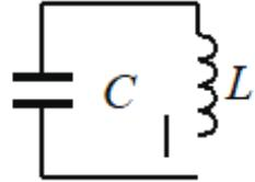
Колебательный контур. Свободные электромагнитные колебания в идеальном колебательном контуре:
